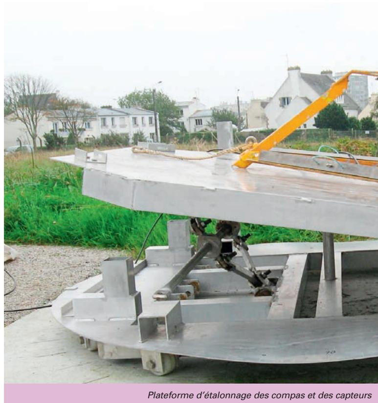
Plateforme d'étalonnage des compas et des capteurs
