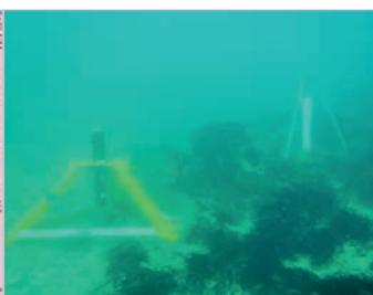
Courantomètre et marégraphe mouillés sur la zone du levé d'accès à Granville
