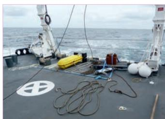
Mouillage ERATO composé de récepteurs acoustiques, d'une balise, de deux flotteurs BASIM et d'un lest, disposé sur le pont avant mise à l'eau en septembre
