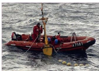
Relevage de la bouée Télémaque de mesure acoustique
