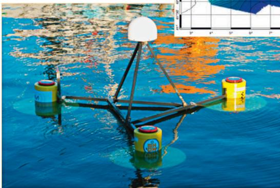
Couverture en Méditerranée des surfaces de référence Bathyelli (cartographie du zéro hydrographique par rapport à l'ellipsoïde GRS80) et mise en œuvre d'un prototype de bouée GPS de mesure de la marée
