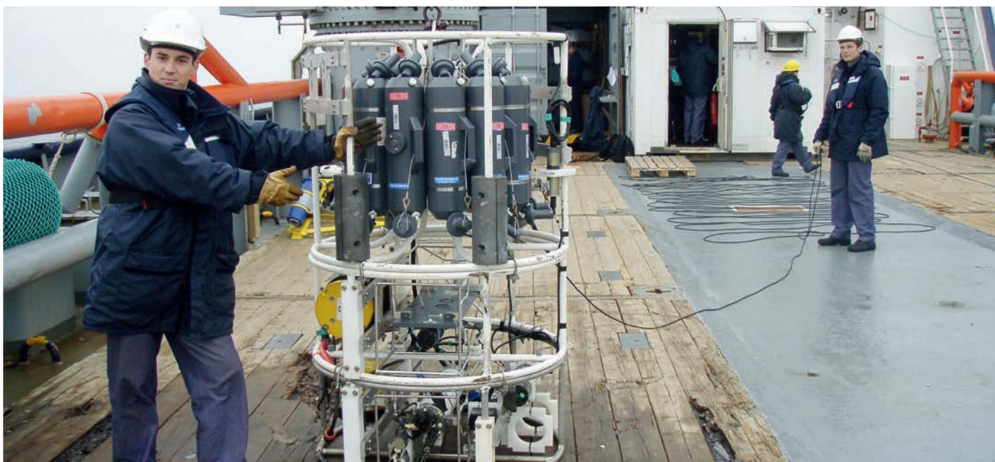
Préparation d'une bathysonde lors de la campagne d'hydrologie en rade de Brest (RADEC) à bord du BSAD Alcyon, dans le cadre du cours du Brevet Supérieur d'hydrographe.
